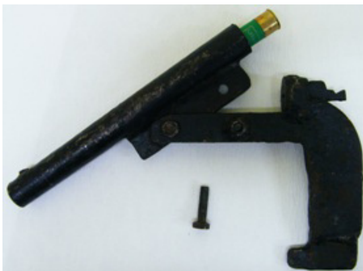
Ručno pravljeni pištolj sa lovačkom municijom
