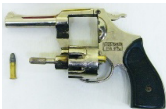
Revolver „Engejac“ sa vidno nepravilno probušenom cevi i sa zamenjenim burencetom prilagođenim da ispali municiju kalibra 6 mm
