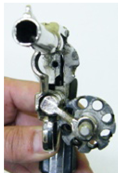
Revolver „Engejac“ sa vidno nepravilno probušenom cevi i sa zamenjenim burencetom prilagođenim da ispali municiju kalibra 6 mm
