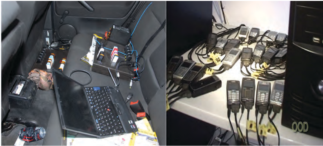
Слика 13: Опрема коришћена за заобилажење рута VOIP телефонског саобраћаја
